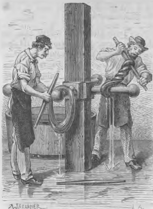
Fig. 213. — Espart ou appareil à tordre les écheveaux.
