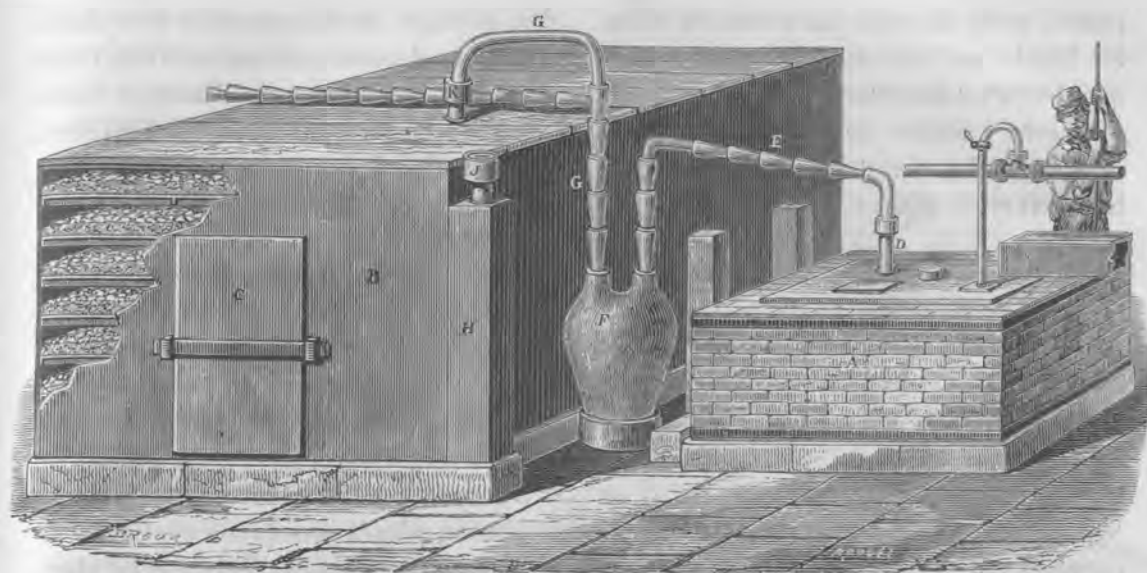
Fig. 212. — Chambre d'absorption du chlore pour la fabrication du chlorure de chaux, avec la cuve de pierre pour la production du chlore.
