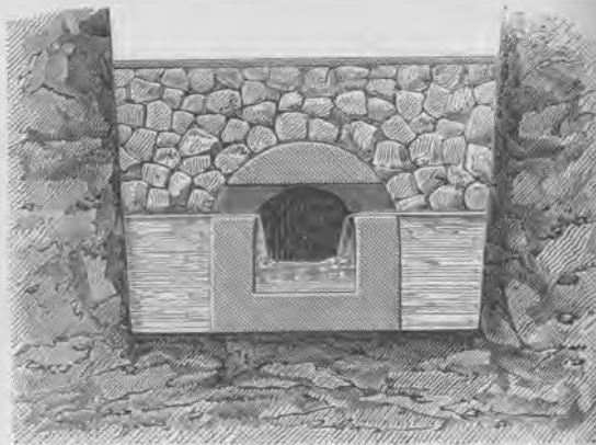
Fig. 96. — Captage des eaux souterraines.
