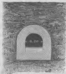
Fig. 109. — Coupe de l'aqueduc d'Avallon.
