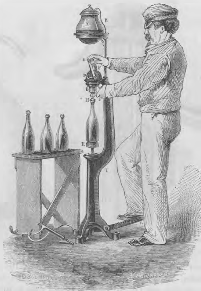
Fig. 196. — Pompe à sirop pour la préparation des limonades gazeuses.
