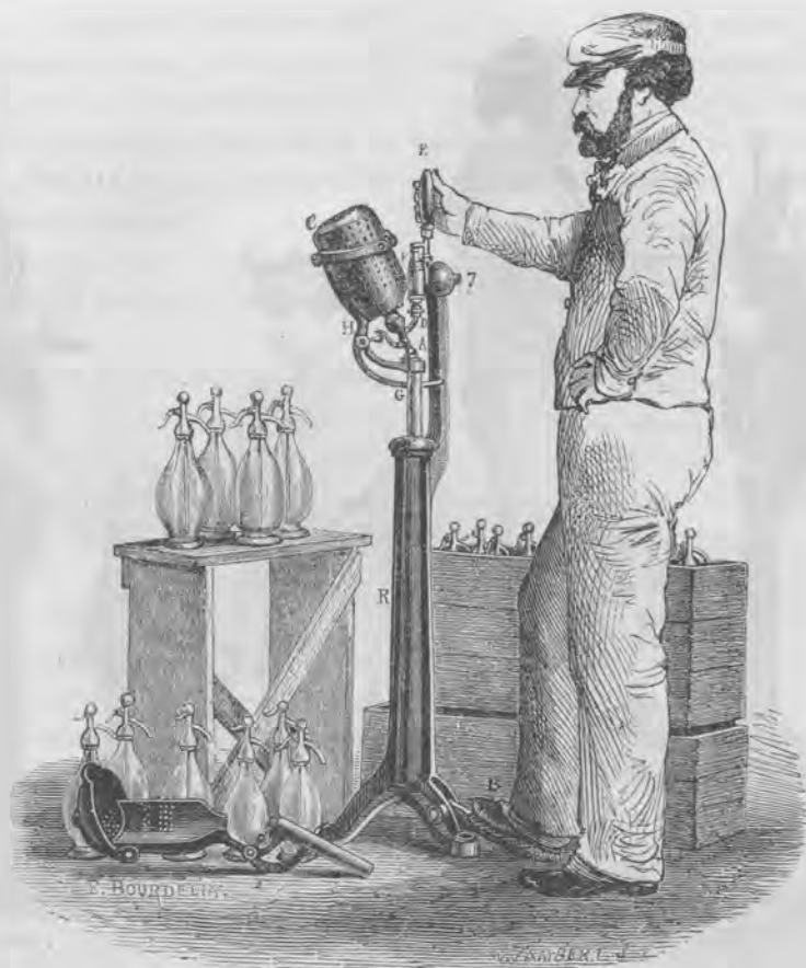
Fig. 193. — Tirage de l'eau de Seltz en siphon.
