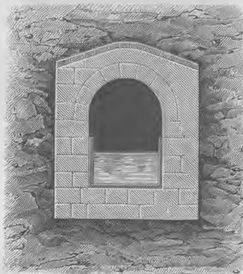
Fig. 108. — Coupe de l'aqueduc de Dijon.
