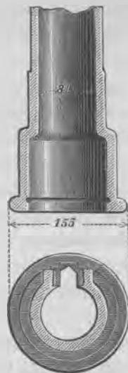
Fig. 119. — Coupe verticale et transversale d'un tuyau de fonte pour la conduite de l'eau.
