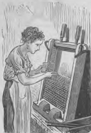
Fig. 251. — Mise en presse à la main des allumettes chimiques.
