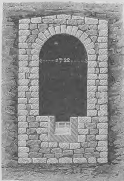
Fig. 107. — Coupe de l'aqueduc de Montpellier.
