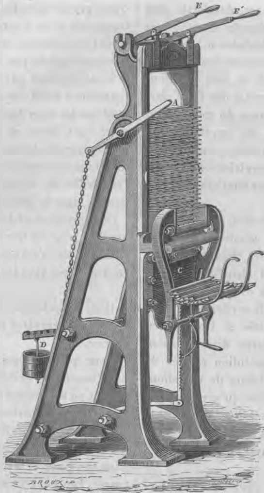
Fig. 257. — Machine de M. Otnar Walch pour dégarnir les cadres des allumettes chimiques.
