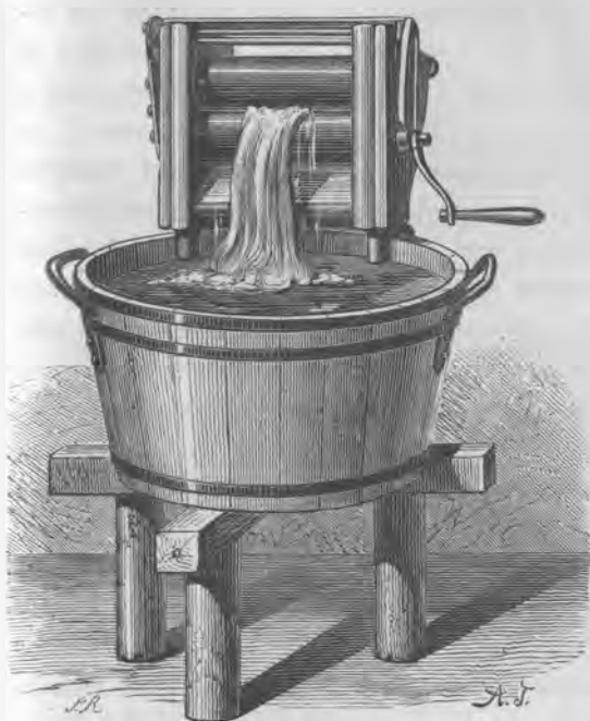
Fig. 224. — Essoreuse de la buanderie à la vapeur.
