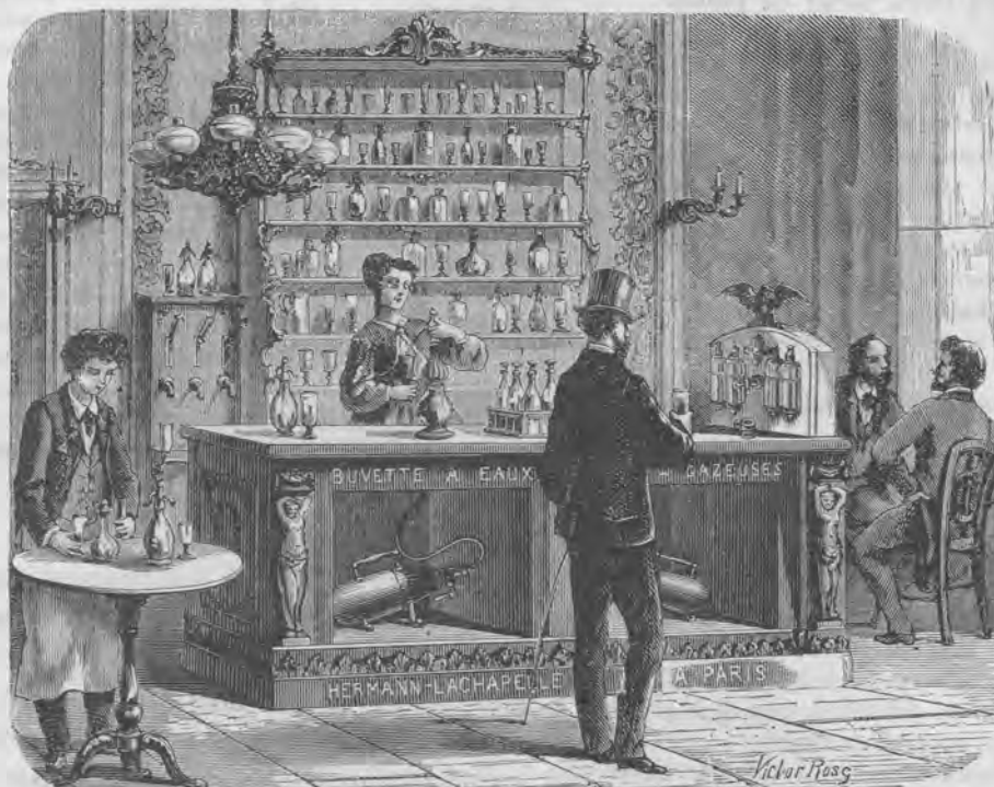
Fig. 200. — Buvette alimentée d'eau de Seltz par un récipient portatif.
