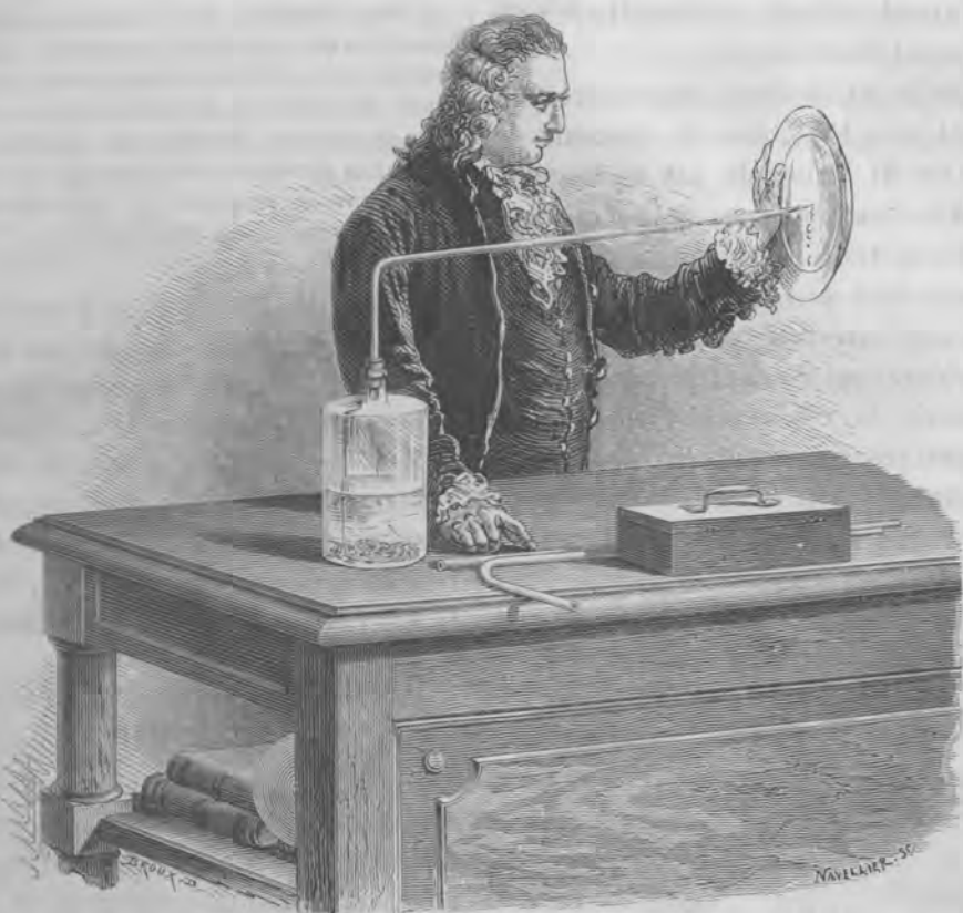
Fig. 3. — Expérience de Macquer. Combustion du gaz hydrogène à l'air, contre une soucoupe de porcelaine.
