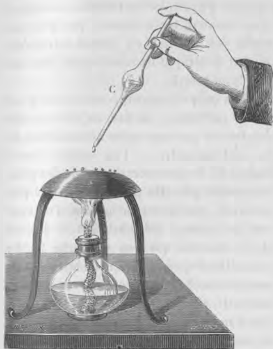
Fig. 52. — Expérience sur l'état sphéroïdal de l'eau.
