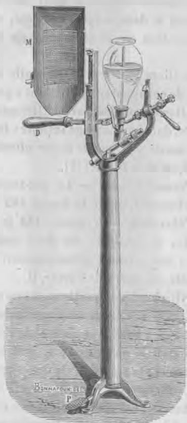
Fig. 182. — Remplissage d'un siphon d'eau de Seltz.
