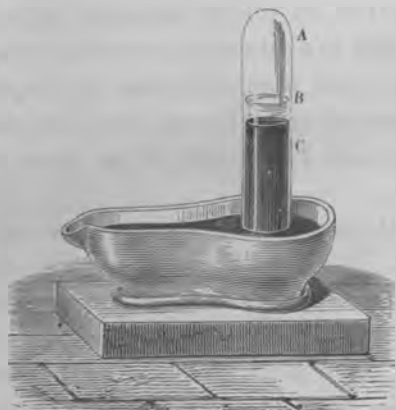
Fig. 10. — Décomposition de l'eau, à froid, par le sodium.
