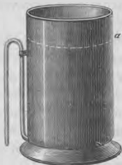
Fig. 210. — Vase de plomb pour l'introduction de l'acide chlorhydrique.
