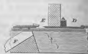
Fig. 247. — Coupe de la filière du rabot mécanique de M. Otmar Walch.
