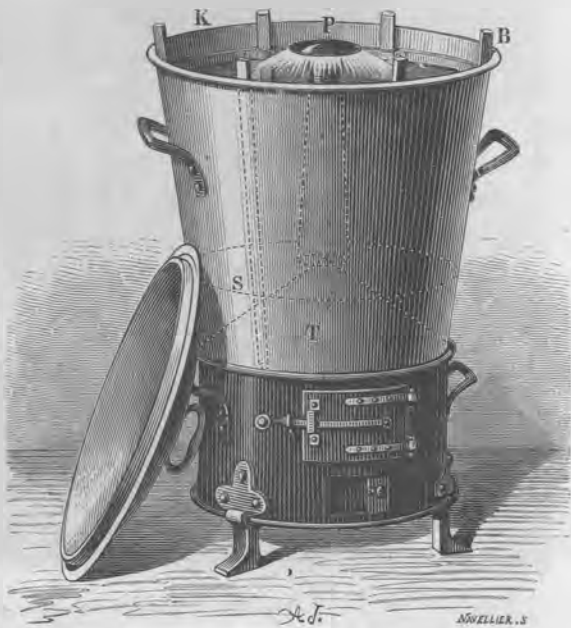
Fig. 227. — Buanderie domestique, ou appareil pour le lessivage par affusion et circulation de la lessive déterminées par la pression de la vapeur.
