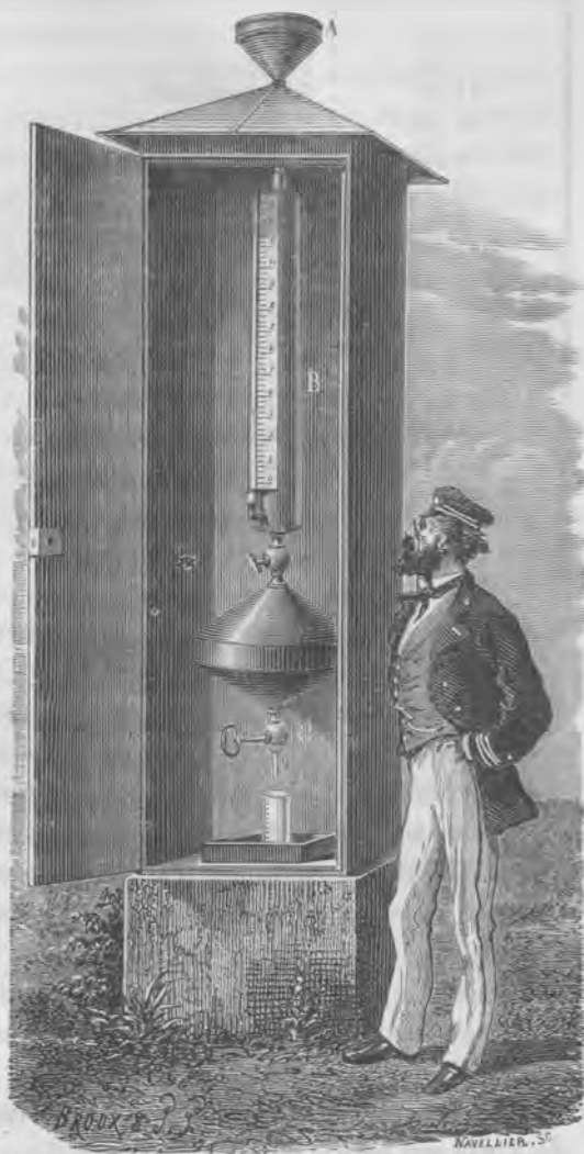
Fig. 60. — Pluviomètre de M. Hervé Mangon.
