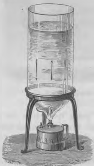
Fig. 30. — Mode d'échauffement de l'eau par des courants verticaux de couches ascendantes et descendantes chaudes et froides.
