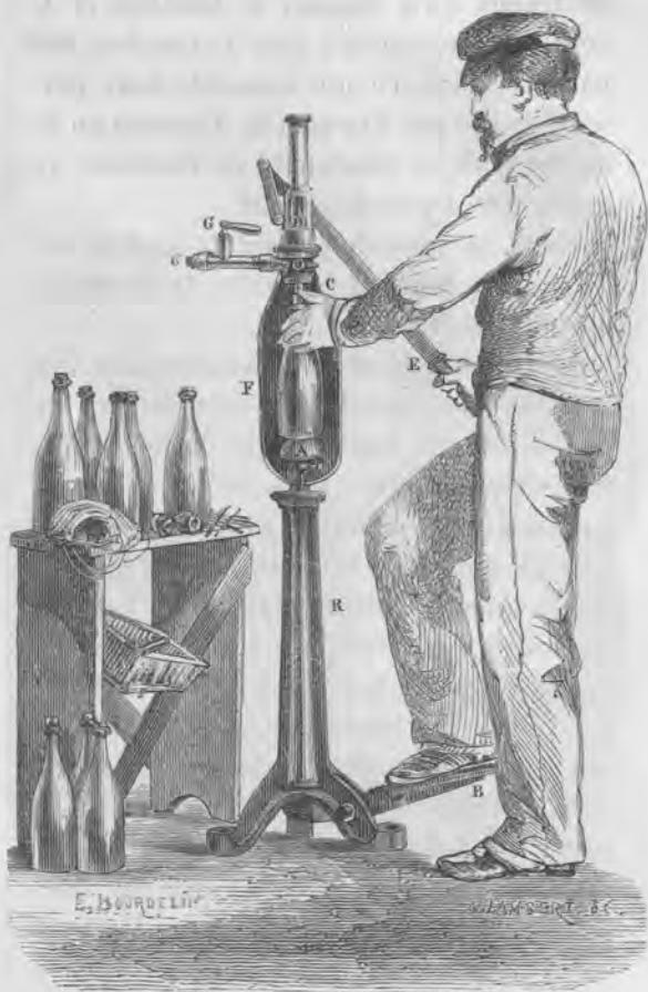
Fig. 190. — Dégagement de la bouteille du cône de tirage.
