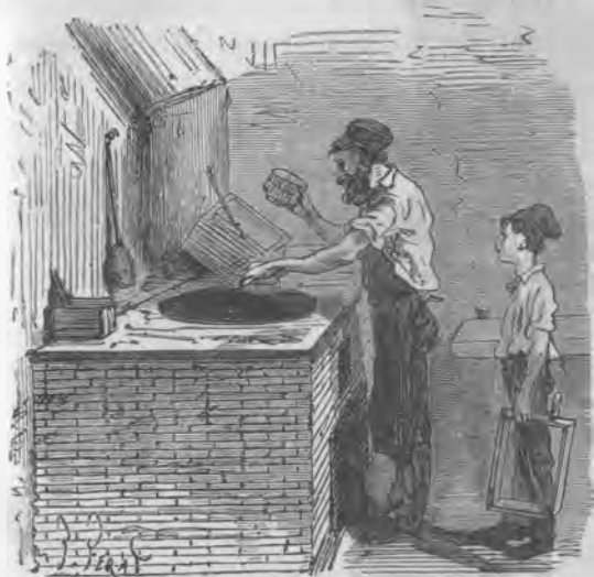
Fig. 249. — Soufrage des allumettes opéré à la main.
