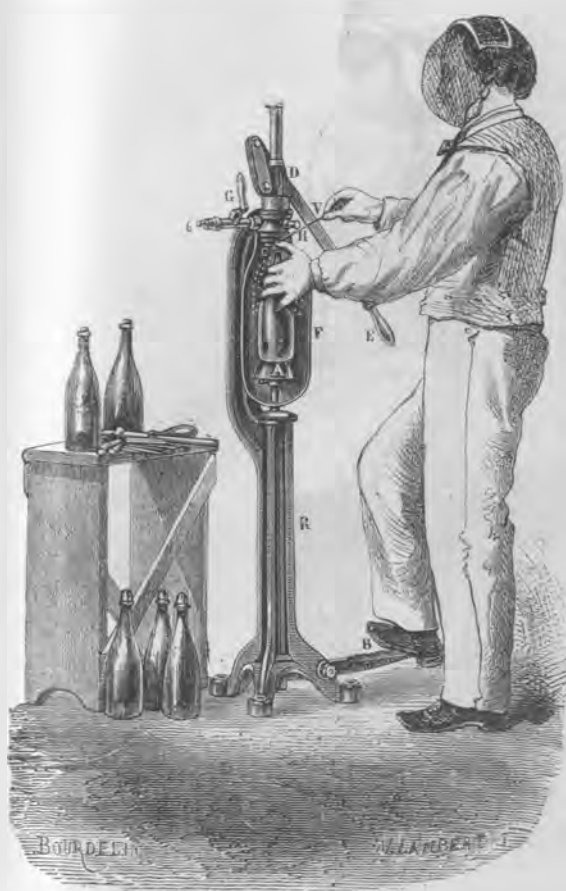
Fig. 191. — Pose de la bandelette de fer blanc autour de la bouteille.
