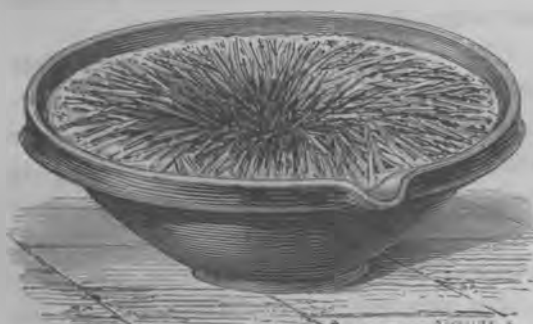
Fig. 31. — Cristallisation de salpêtre par le refroidissement d'une dissolution faite dans l'eau bouillante.
